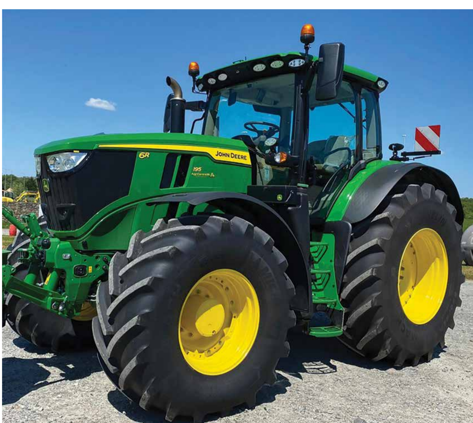
Exemple John Deere 195R Puissance 200 cv Poids à vide 8.6T - essieu AV 2.8T - AR 5.8T Pneu 650/85 R38 AR et AV 600 70R28 Poids : 0.87 kg/cm 2 sur 6648 cm 2 / 2 pneus
