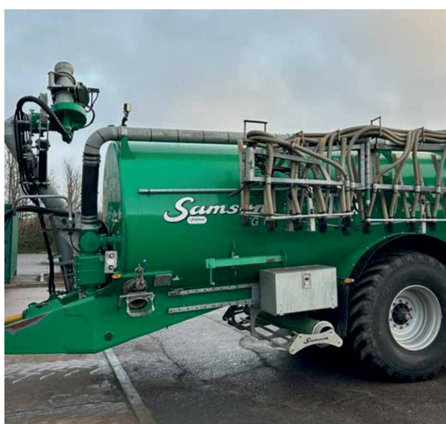
Exemple Tonne à lisier Samson Volume 18 000 L Poids à vide 12.1T - Essieu n°1 5.5T n°2 6.5T Poids à plein 30T - Essieu n°1 13.3T n°2 13.7T Pneu 750/60 R 30.5 Poids : 2.6 kg/cm 2 sur 5250 cm 2 / 2 pneus
