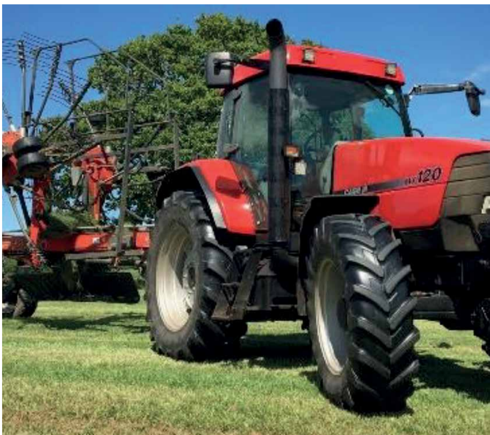
Exemple Case MX 120 Puissance 120 cv Poids à vide : 6.2T - Essieu AV 2.7T - AR 3.5T Pneu 580/70 R38 AR et 480 70 R28 AV Poids : 0.96 kg/cm 2 sur 3660 cm 2 / 2 pneus
