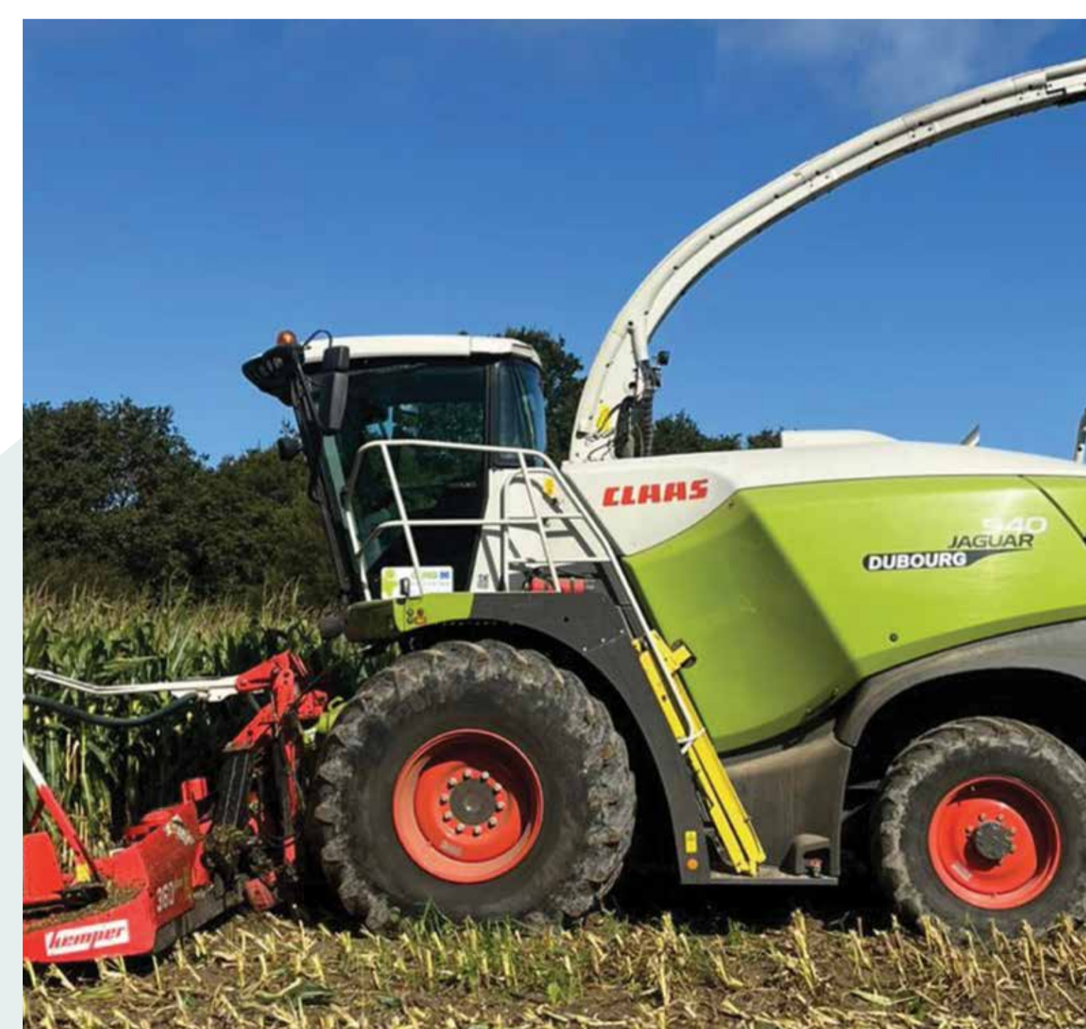
Exemple Claas 940 Cueilleur 8 rangs - Puissance + 500 cv Poids total 16T - Essieu AV 10 T - AR 6 T Pneu 800/70 R32 AV et 600/65 R28 AR Poids : 1.1 kg/cm 2 sur 9254 cm 2 / 2 pneus
