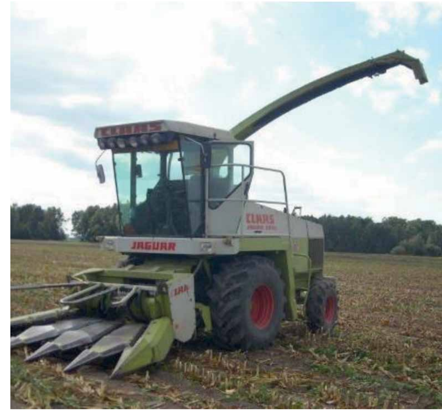
Exemple Claas 690 Cueilleur 4 rangs - Puissance 300 cv Poids total 9T - Essieu AV 6T - AR 3T Pneu 540/65 R30 AV et 420/65 R20 AR Poids : 1.4 kg/cm 2 sur 4168 cm 2 / 2 pneus
