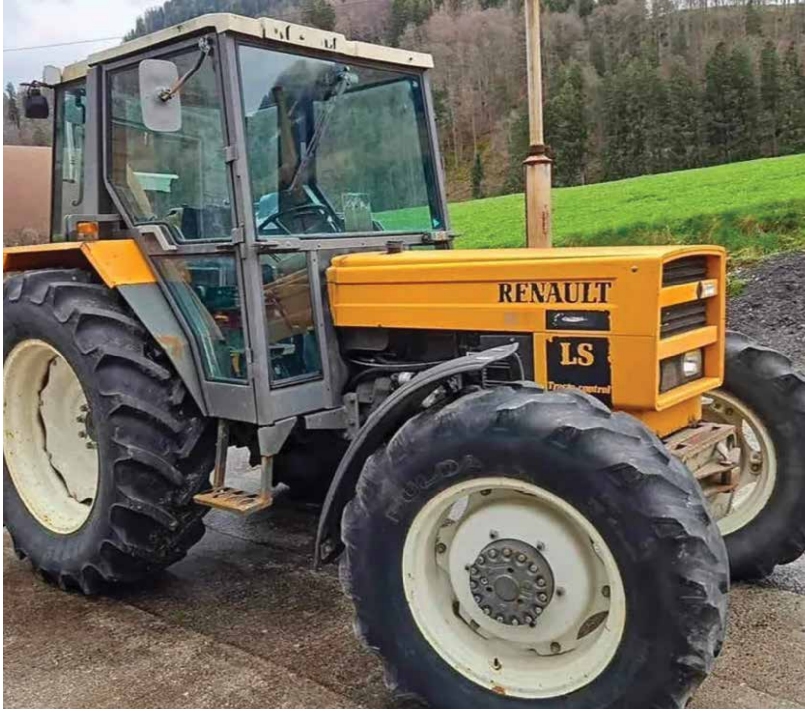
Exemple Renault 85 - 14 LS Puissance 85 cv - poids à vide : 3.6T Essieu AV 1.5T - AR 2.1T Pneu 480/70 R34 AR et 380/70 R24 AV Poids : 0.87 kg/cm 2 sur 2412 cm 2 / 2 pneus
