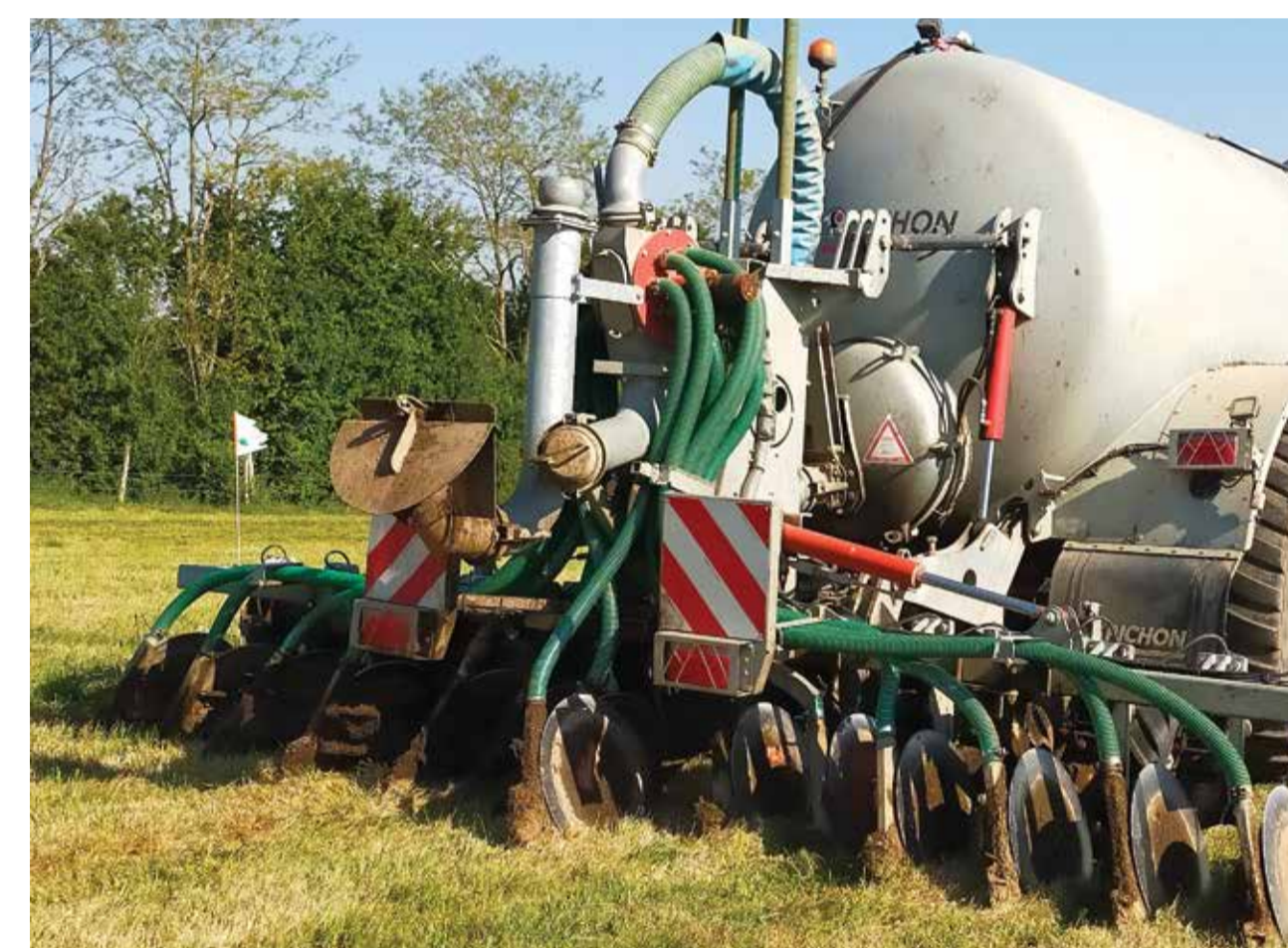
tonne à lisier avec enfouisseur
