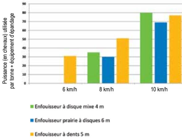
Plus 3 km/h augmente d'environ 50 % le besoin de puissance
