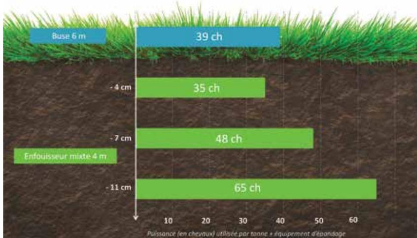
> Buse ou enfouisseur à faible profondeur = même besoin de puissance
