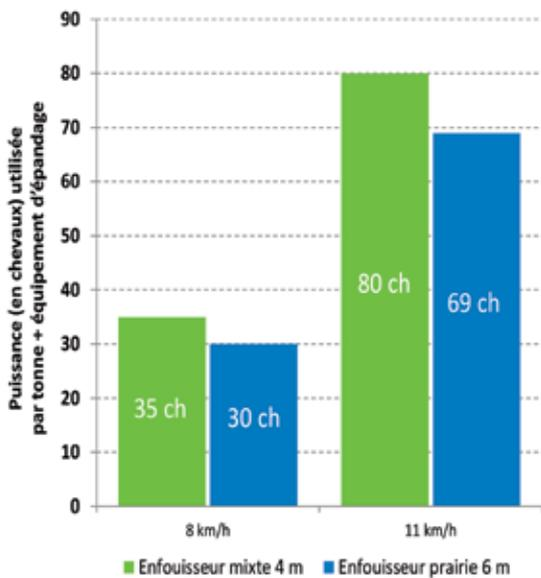
Plus 3 km/h augmente d'environ 50 % le besoin de puissance
