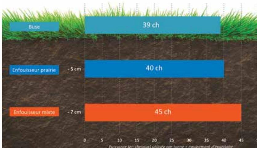
Enfouisseur à disques ou buse à largeur identique, = un besoin de puissance similaire
