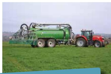
La cuma a investi en 2021 dans une tonne de 21 m<sup>3</sup> avec une rampe de 18 m et un tracteur de 250 ch est attelé.
