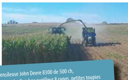
La cuma est équipée d'une ensileuse John Deere 8300 de 500 ch, achetée 393 000 € en 2020, montée d'un bec cueilleur 8 rangs, petites toupies et d'un pick-up en 3m. Prestation de chantier complet avec :
